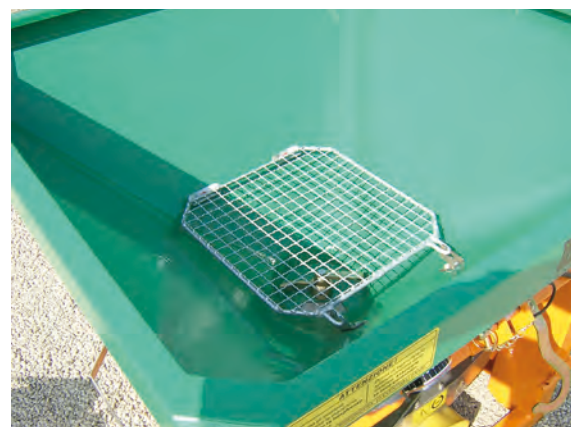
Griglia mobile nella tramoggia
